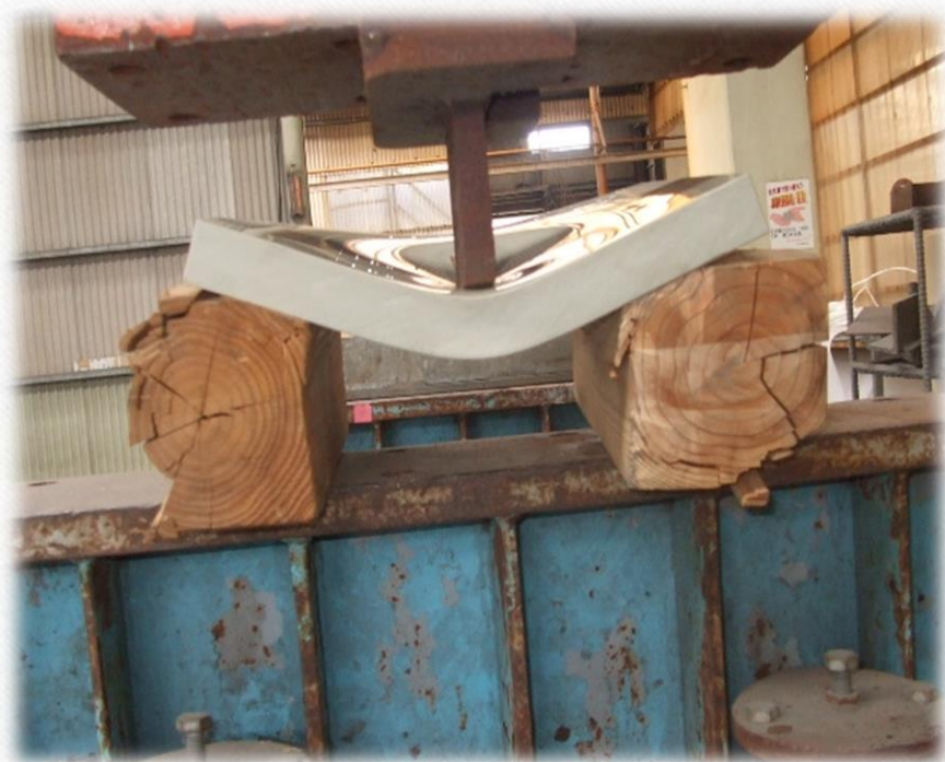
② 100トンプレスによる曲げ試験
